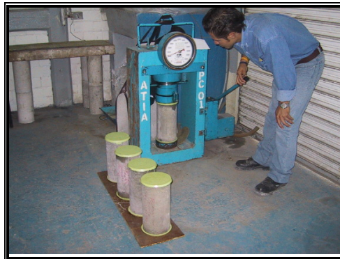
Figura 4.26. Ensayo a compresión simple.
